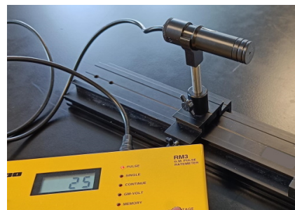
Figur 3.4: Et Geiger-Müller-rør tilsluttet en tæller.
