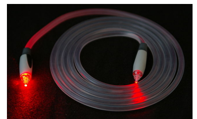
Figur 3.5: Lyslederkabel. Det venstre stik på kablet bliver belyst med en rød laser; lyset bevæger sig gennem kablet og ud ad det højre stik.[16]
