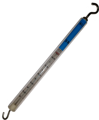
Figur 1.4: Et dynamometer der kan måle kræfter op til 5 N.
